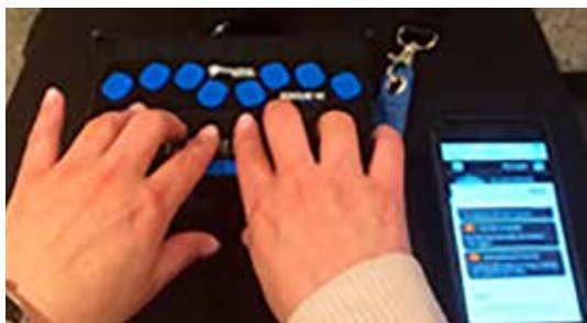
Braille-tastatur (blå taster), som er koblet til en mobiltelefon, og som har en liten braille leselist i forkant.
